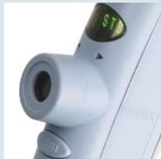
È l'elaborazione intelligente di questi segnali a permettere al processore interno di calcolare con precisione la posizione dello strumento rispetto all'occhio del paziente ad ogni frazione di millisecondo, per cui un evento (emissione d'aria) ha luogo solo in caso di perfetto allineamento.
