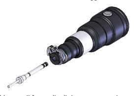
3. Abbassare il fermaglio di sicurezza per assicurare che blocchi il tubo all'estremità del connettore.
